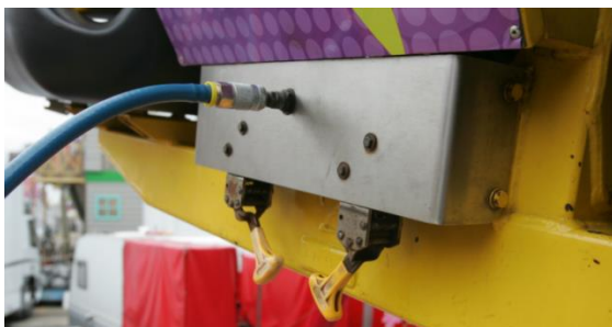
Photo n°7 : Commande de déverrouillage de secours des harnais
