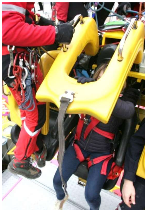
Déverrouillage des 8 arceaux, retrait de la sangle entre-jambes du seul arceau du passager à descendre, ouverture complète.
