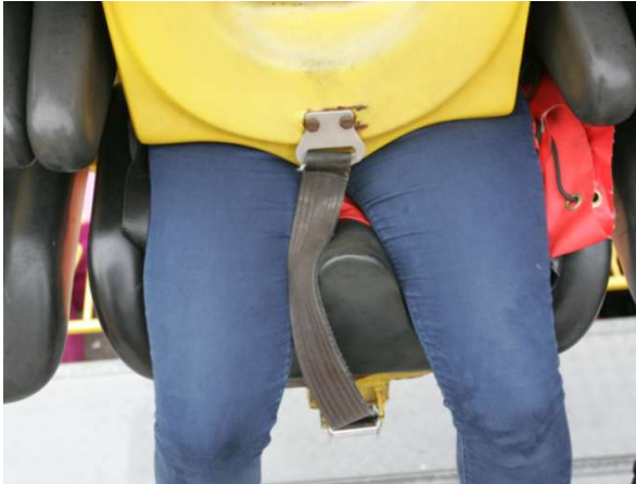
Arceau plaqué sur les cuisses, sangle entre-jambes.
